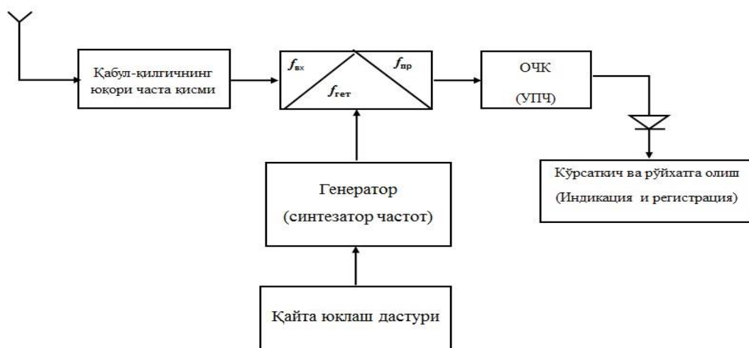
1.2. чизма. Сканер килувчи приёмниклар чизмаси
