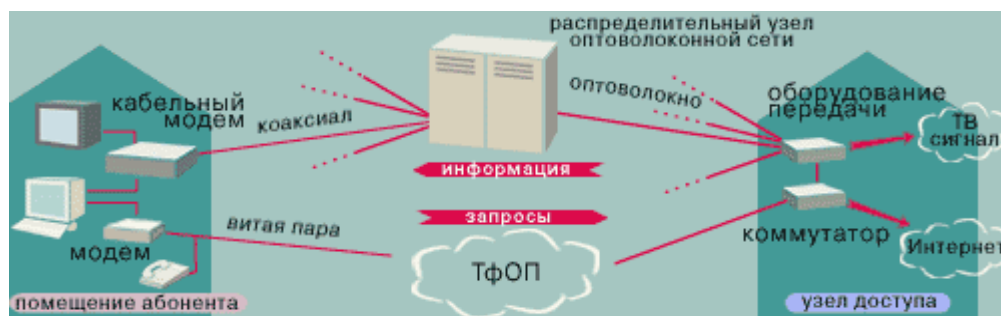
Рисунок 1 - Совместное использование оптики и медного кабеля
