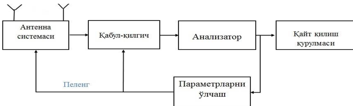
1.1.чизма. Станциянинг соддалаштирилган структуравий схемаси
