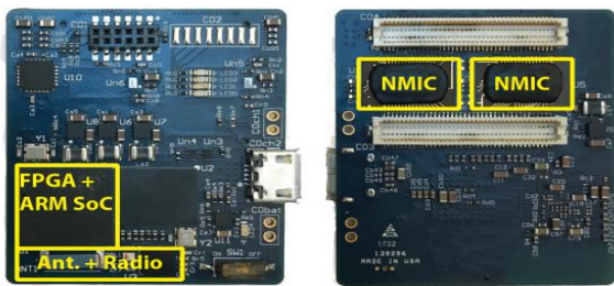
2-rasm. a) Muhim bloklari izohlangan biosignal simsiz olish qurilmasi, b) Simsiz biosignal olish qurilmasining texnik xususiyatlari
