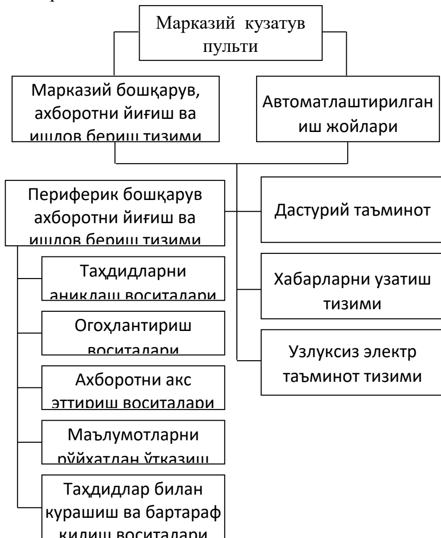
1- расм. Хавфсизлик комплекс тизимининг умумлаштирилган тузилмавий схемаси
