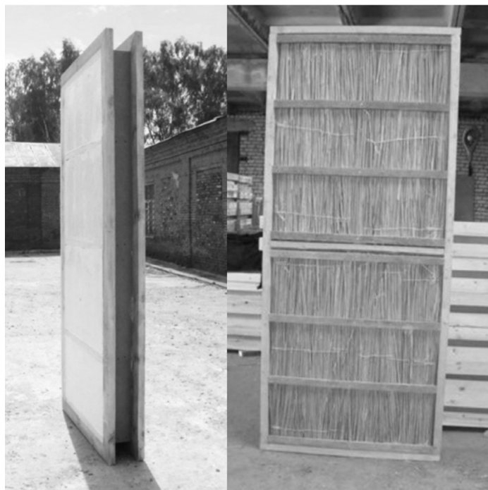
Рис. 1. Общий вид пенополиуретановой камышитовой панели с утеплителем и без него
