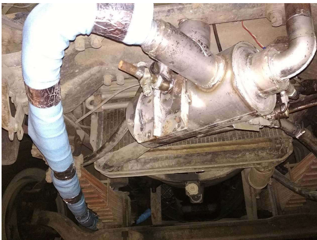
Рис. 3. Усовершенствованный предпусковой подогреватель на автомобиле
