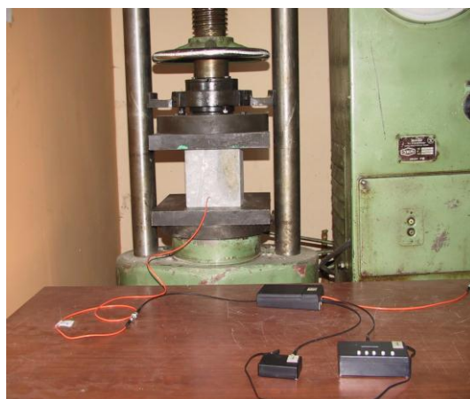
Рис. 3 Лабораторные испытания волоконно–оптического датчика деформаций, заделанного в бетонный кубик 150×150 мм. ООО «Мониторинг–Центр»
