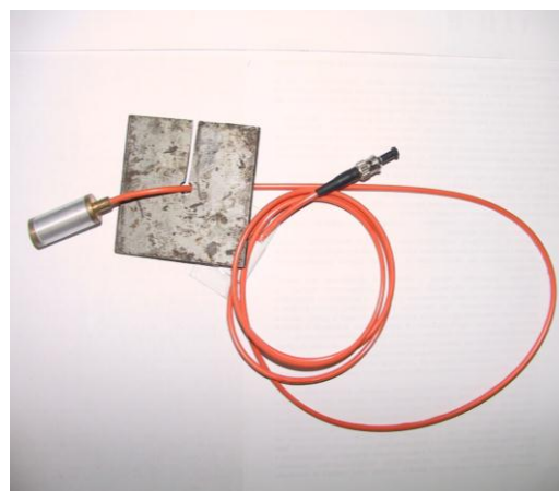
Рис. 4 Волоконно–оптический сенсор деформаций амплитудного типа. ООО «Мониторинг–Центр»
