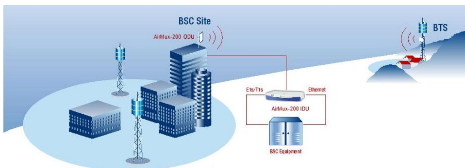
1-расм. AirMux-200 қурилмаси ёрдамида узоқ масофада жойлашган ҳарбий қисмлар билан алоқани ташкил қилиш схемаси.
