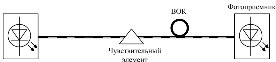
Рис.2б. Точечный ВОД проходного типа с чувствительным элементом
