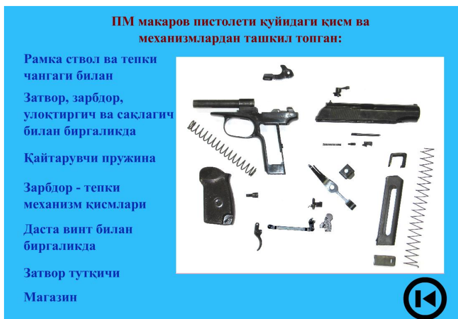
2 - расм. 9 мм ли ПМ пистолетининг қисм ва механизмлари.
